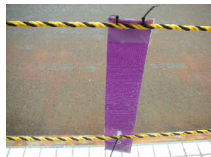
④シートのめくり上がりを防ぐには裏側の白いタグに取付けバンドを通す。 その際、 風に揺れるよう ロープに緩めに留める。
